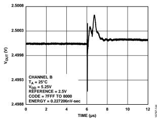
Figure 30. Digital-to-Analog Glitch Impulse
