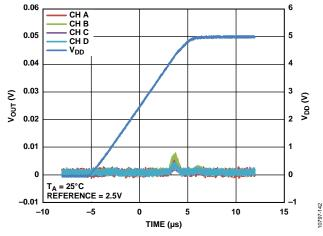
Figure 28. Power-On Reset to 0 V
